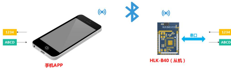
图 4 一对一蓝牙连接透传功能示意图
